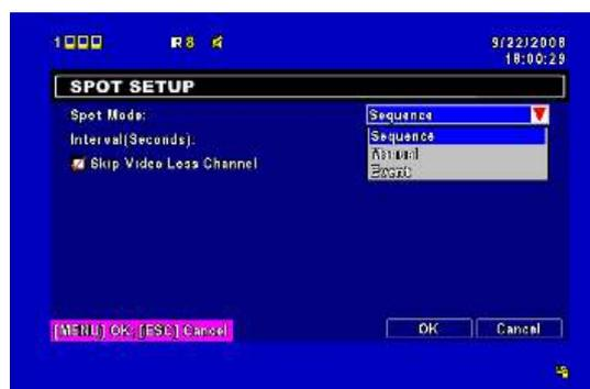
Der AEON 800 bietet Ihnen 2 Möglichkeiten der Video-Ausgabe: Die eine Möglichkeit ist der Hauptvideo-Ausgang, die andere Möglichkeit ist der Spot-Monitor-Ausgang: Der Spotmonitor-Ausgang blendet fortlaufend alle Kamerakanäle hintereinander in einer Endlosschleife kurz ein. Die Intervallzeit kann von Ihnen bestimmt werden. Um diese Funktion zu nutzen, müssen Sie einfach nur einen Monitor an den Spot-Monitor-Ausgang des Rekorders anzuschließen.
