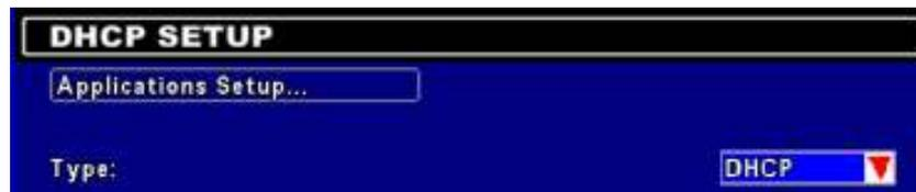
Wenn Sie das DHCP-Protokoll auswählen, wird eine IP-Adresse automatisch von Ihrem DHCP-Server vergeben (z.B. von Ihrem DSL- oder Kabel-Router). Diese Methode wird bei Verwendung einfacher Internet-Verbindung per Router empfohlen.
